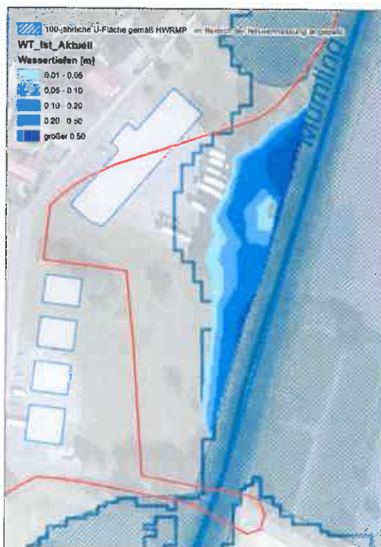
Abb. 10: Auf Grundlage der Neuvermessung in Höhe des Bauvorhabens auf der linken Gewässerseite ermittelte Wassertiefen und neu berechnete Wasserspiegellagen
